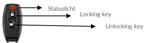
**Unlocking key:** Drücken Sie die Entriegelungstaste zum Entriegeln, die Statusleuchte flackert
