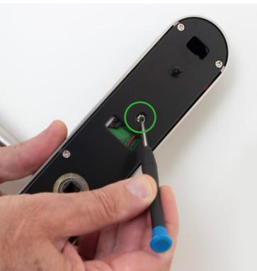
Der Reset-Taster befindet sich im Batteriefach vom Innenbeschlag. Diesen für ca. 5 Sekunden drücken bis ein langer Ton ertönt. Der Türbeschlag kann nach einem Code fragen. Dieser Code lautet "000#". Der Türbeschlag bestätigt dann, dass alle Einstellungen zurückgesetzt wurden.
