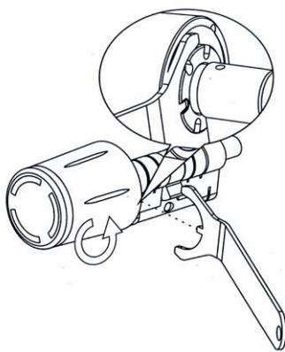
Um den Deckel des Außenknaufs zu öffnen, verwerde bitte den in der Verpackung enthaltenen Spezialschlüssel und drehe den Knauf gegen den Uhrzeigersinn.
