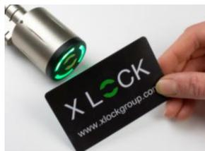
3. Aktiviere den Zylinder, indem Du eine RFID-Karte an der Antennenfläche identifizierst.
