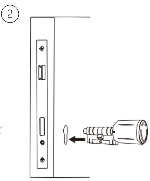
Setzen Sie den XLOCK Zylinder von außen in das Profilzylinderloch ein.
