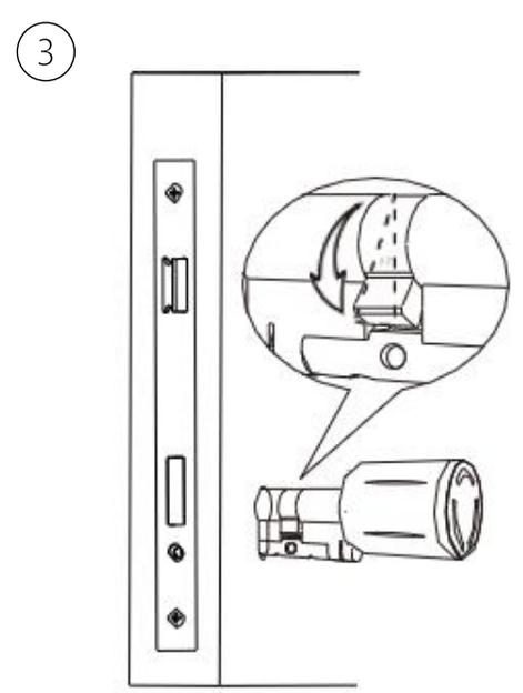
Stelle die Schließnase bündig, damit der Zylinder eingesetzt werden kann.
