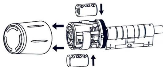
Den Zylinderdeckel abziehen und die 2 Batterien in der richtigen Polarität einlegen.
