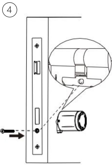
Befestige den Zylinder mit der Zylinder Schraube.
