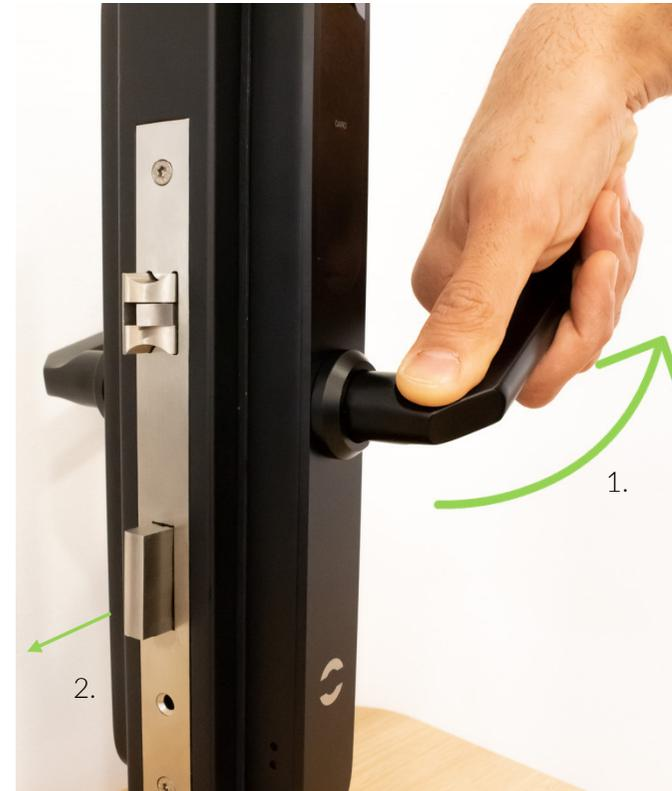
Es gibt spezielle Einsteckschlösser bei denen durch Anheben vom Türdrücker, siehe Abbildung, der Riegel versperert wird. Durch Betätigung des Türdrückers wird der Riegel und die Falle zurückgezogen und die Türe entriegelt. Der XLOCK H20 Türbeschlag unterstützt diese sichere Verriegelungsmethode. Alternativ können auch selbstverriegelnde Panikschlösser eingesetzt werden.
