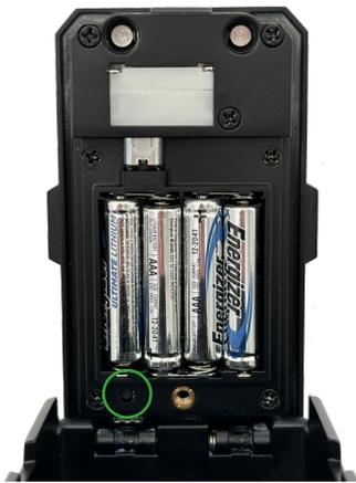
Wenn Sie die Smartbox nach dem Einlegen der Batterien nicht in der Suchliste des XL Lock Managers sehen, können Sie das Schloss zurücksetzen. Suchen Sie dazu den Reset-Knopf auf der Rückseite der Vorderschale. Wenn das Gerät eingeschaltet/geöffnet ist, drücken Sie die Reset-Taste 3 Sekunden.
