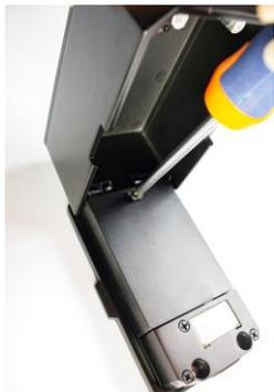
Batteriefachdeckel öffnen und die Batterien mit der richtigen Polarität (+/-) einlegen.
