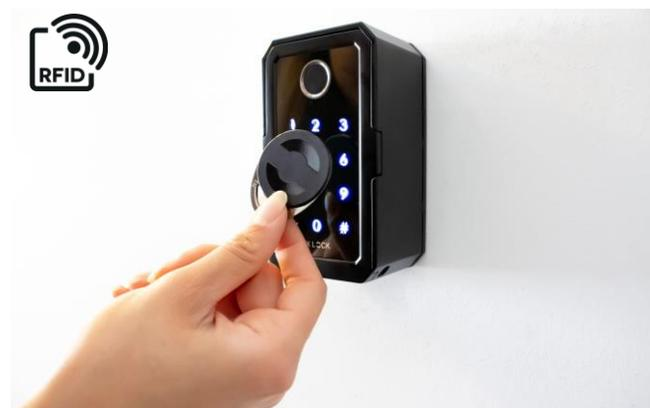
Halte einen programmierten Transponder an die Antenne vom Schloss. Der Leseabstand ist abhängig vom Einbau und dem Medium. Das Schloss entriegelt, die Smartbox kann geöffnet werden. Nach 5 Sekunden verriegelt sich die Smartbox automatisch. Die Verriegelungs-Zeit kann in der App in den Schloss Einstellungen angepasst werden: 5-900 Sekunden
