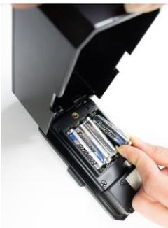
Batteriefachdeckel schließen und mit der Schraube fixieren.
