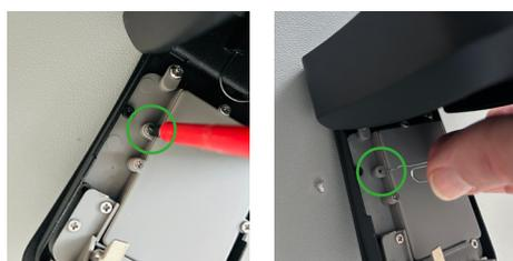
Wenn Sie das Schloss nach dem Einlegen der Batterien nicht in der Suchliste des XL Lock Managers sehen, können Sie das Schloss zurücksetzen. Suchen Sie dazu den Reset-Knopf auf der Rückseite der Vorderschale. Wenn das Gerät eingeschaltet/geöffnet ist, drücken Sie die Reset-Taste 3 Sekunden.
