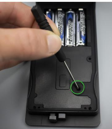
Wenn Sie die Smartbox nach dem Einlegen der Batterien nicht in der Suchliste des XL Lock Managers sehen, können Sie das Schloss zurücksetzen. Suchen Sie dazu den Reset-Knopf auf der Rückseite der Vorderschale. Wenn das Gerät eingeschaltet/geöffnet ist, drücken Sie die Reset-Taste 3 Sekunden.
