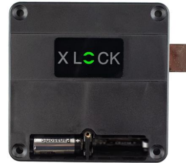
Batterie wird mit der richtigen Polung eingelegt -> System und RFID Feld ist aktiviert
