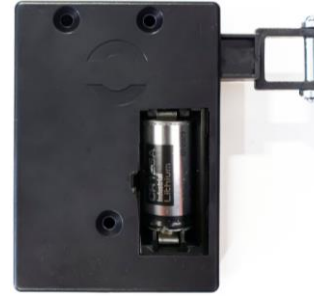
Batterie wird mit der richtigen Polung eingelegt -> System und RFID Feld ist aktiviert
